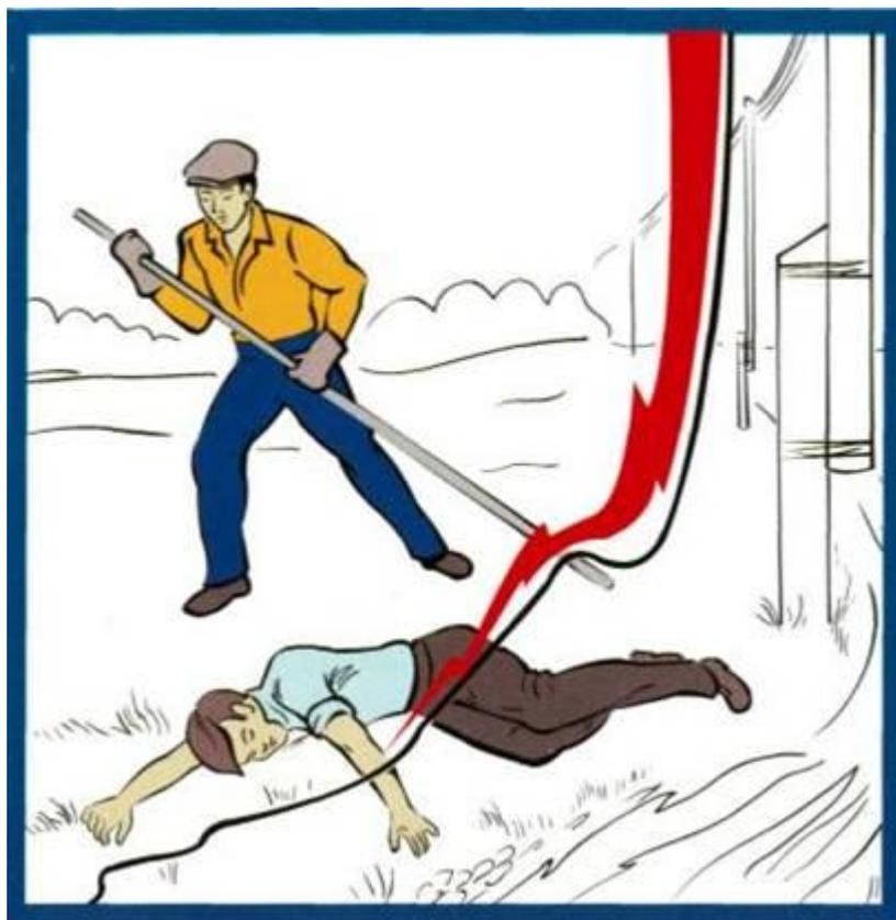
Рис.6. Освобождение пострадавшего от токоведущей части, находящейся под напряжением до 1000 В
